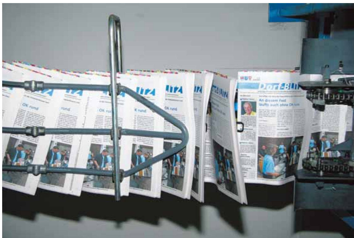
Der gefaltete Dorf-Blitz wird in diesem Arbeitsprozess gschnitten. Die hier noch sichtbaren Farbkeile am oberen Rand der Zeitung dienen den Druckern zur Qualitätsüberprüfung.
