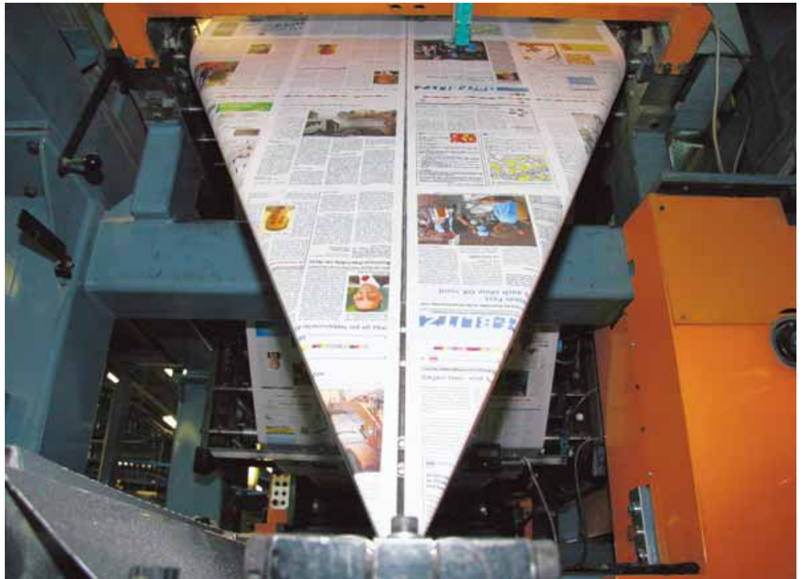
Die fertig gedruckte Zeitung wird über die Falzmaschine geführt. Danach erscheint jede Seite auf ihrem richtigen Platz. (Bilder: Stefan Forster)
