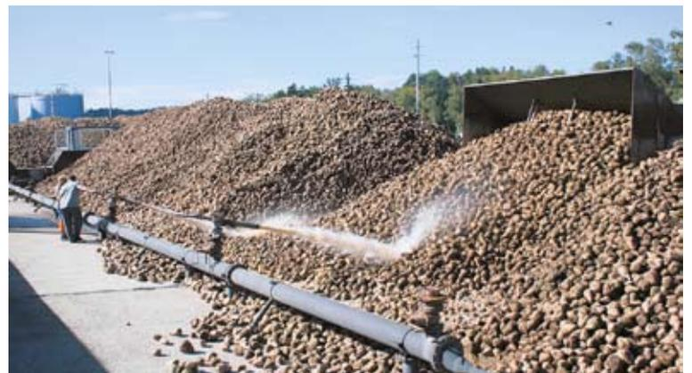
Hier werden die Rüben abgeladen und mit Hochdruckpumpen transportiert.
